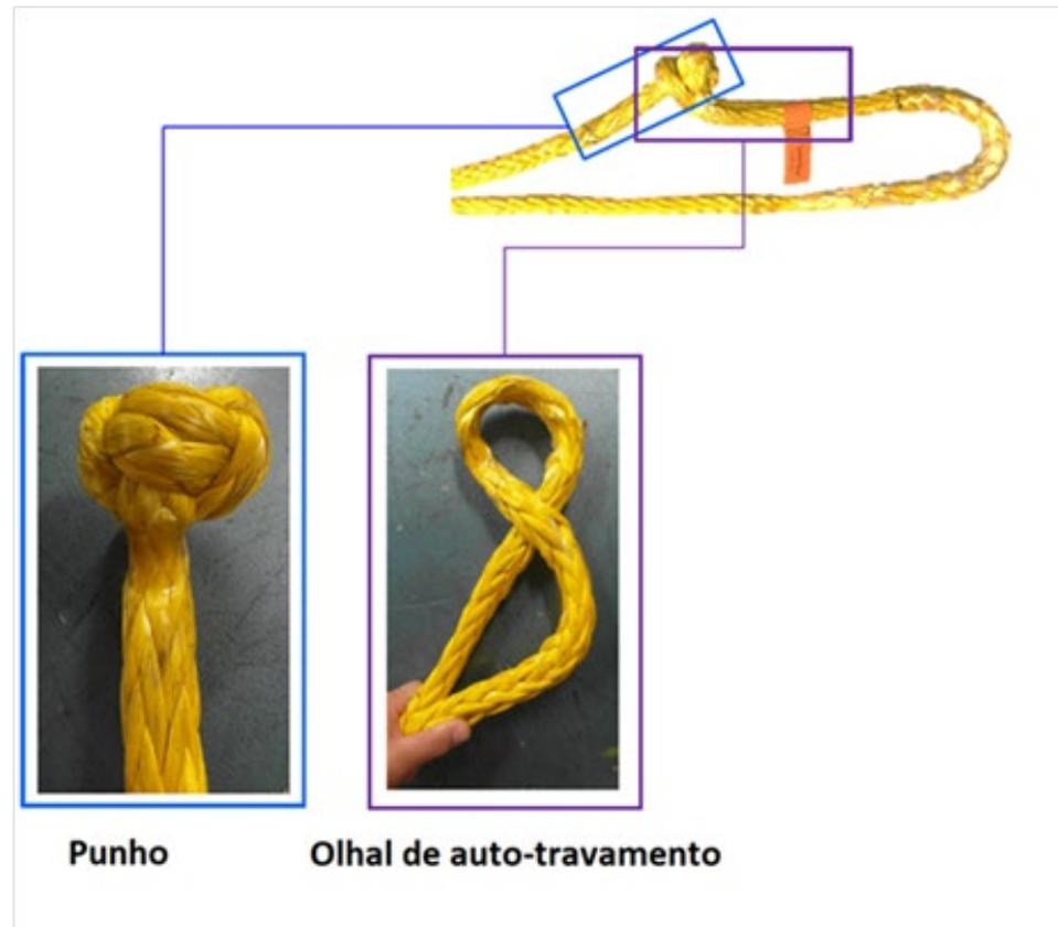
2. Passo a passo – Proteção dos Olhais, recomendasse que se faça o pedido do cabo para a fábrica já incluindo essas proteções.
